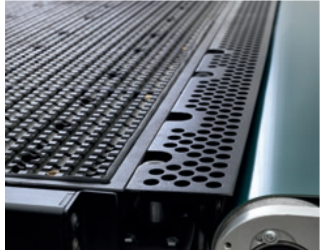
Sistema di aspirazione trucioli disposto tra la macchina ed il tappeto di scarico, garantisce la massima pulizia dei pezzi.
